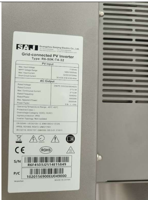
Inversor SAJ R6-50K-T4-32 de 50 kWp
